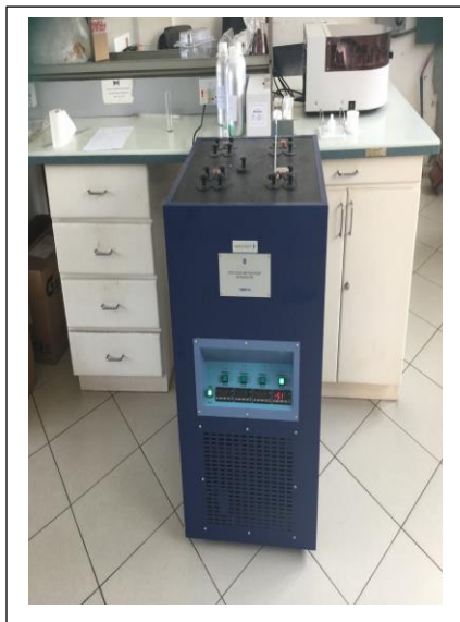
Fig 3.7a SETA Cloud and Pour point refrigerator
